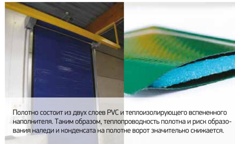
Полотно состоит из двух слоев PVC и теплоизолирующего вспененного наполнителя. Таким образом, теплопроводность полотна и риск образования наледи и конденсата на полотне ворот значительно снижается.
