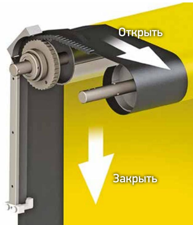
Двигатель тянет полотно вверх при открывании ворот и толкает вниз при закрывании. Для всех моделей.
